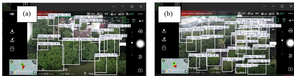
Gambar 8 Perbandingan pembacaan model fine-tuning (a) dan standar (b) pada ketinggian terbang 70 m.
