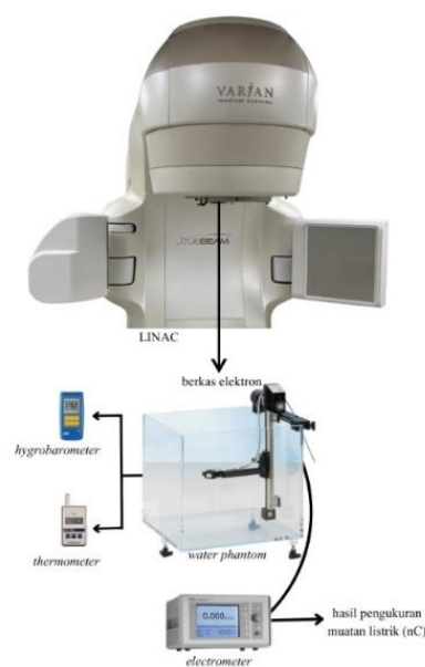
Gambar 1 Diagram proses pengukuran jumlah muatan listrik (nC)
