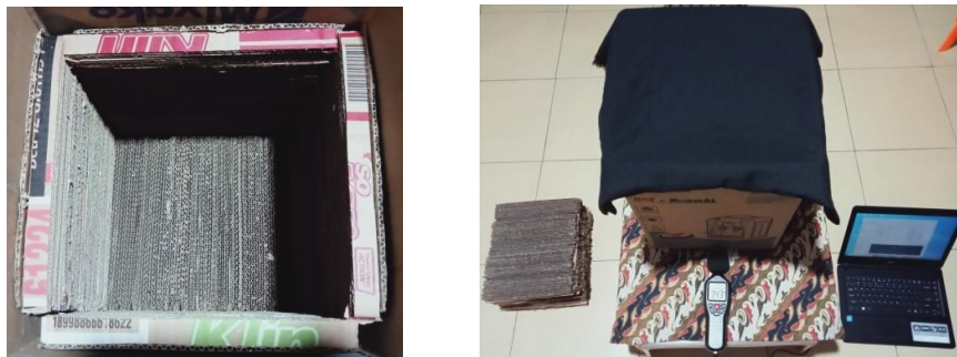
Gambar 1 Proses uji koefisien serap material akustik berbahan kardus
