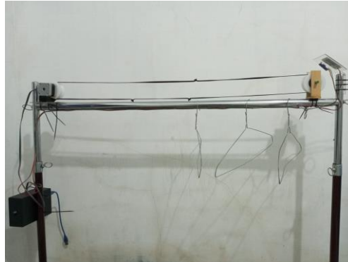
Gambar 3 Rancangan Sistem Otomatisasi Penjemuran Pakaian
