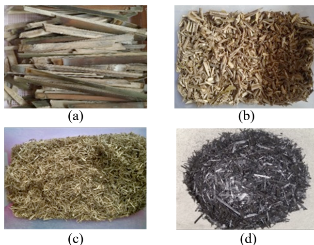
Gambar 1 (a) Potongan bambu (b) Bambu yang sudah dicacah (c) Bambu yang sudah dihaluskan (d) Hasil karbonisasi bambu
