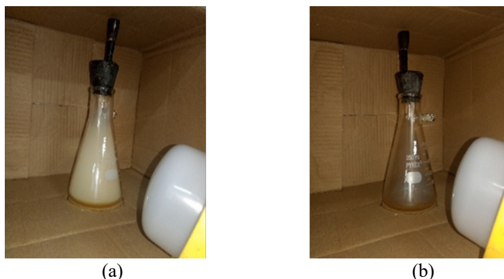
Gambar 4 (a) Filtering flask digunakan untuk menampung asap rokok (b) Nanopartikel TiO 2 menghilangkan asap setelah terpapar cahaya tampak (LED)
