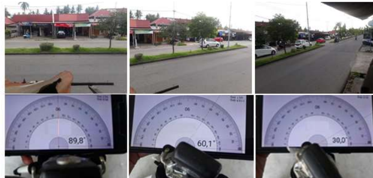
Gambar 4 Hasil citra dan posisi kamera dengan variasi sudut 89,8^\circ ; 60,1^\circ dan 30^\circ
