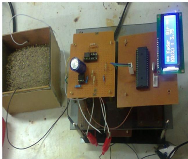
Gambar 6 Alat ukur kadar air agregat halus (pasir)
