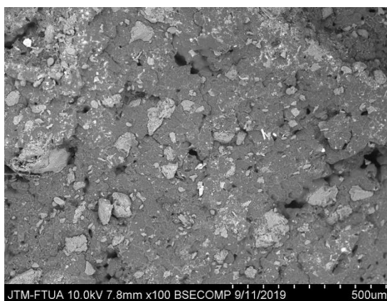
Gambar 6 Foto SEM Patahan Sampel dengan Perbesaran 100x
