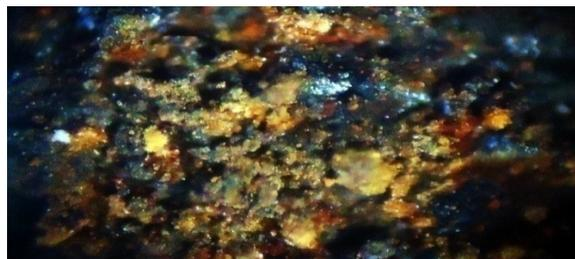
Gambar 6 Spesimen baja pada medium korosif NaCl setelah dilapisi ekstrak daun teh pada perendaman 3 hari
