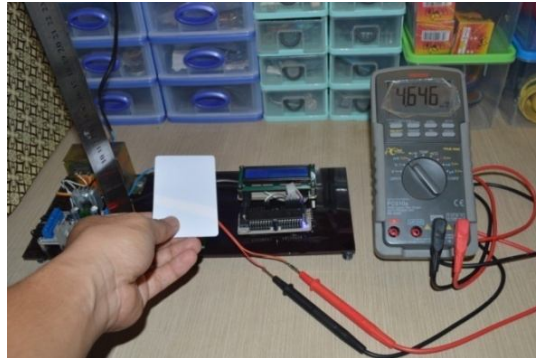
Gambar 3 Hasil pengujian pembacaan frekuensi
