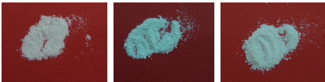
Gambar 1 Hasil sintesis silika dengan variasi (a) NaOH 5 M, (b) NaOH 6 M, (c) NaOH 7 M
