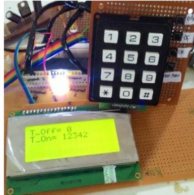
Gambar 7 Bentuk fisik hasil rancang-bangun rangkaian sistem minimum mikrokontroler, keypad, dan LCD
