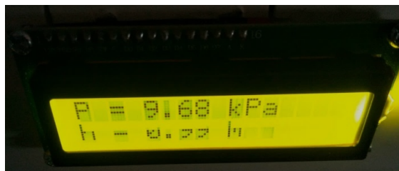
Gambar 7 Penampil Hasil Pengukuran Tekanan Hidrostatik dan Kedalaman Perairan pada LCD
