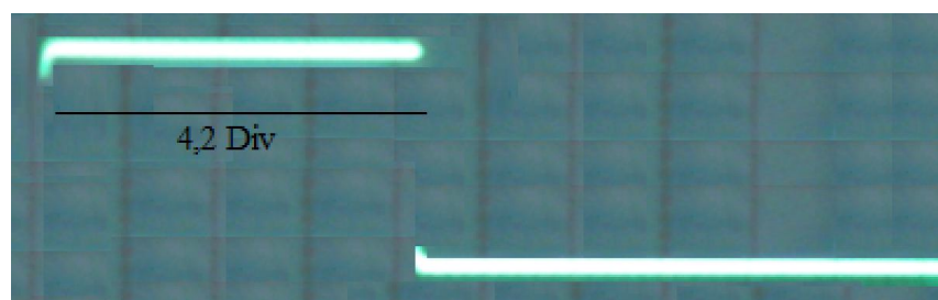
Gambar 7 Bit time untuk satu bit data digital serial
