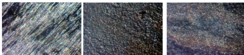
Gambar 3 Morfologi permukaan pelat baja (a) Pelat baja SS-304 dan Baja yang telah dielektrodeposisi 30 menit dan direndam 21 hari dengan konsentrasi (b) 0% (c) 3%
