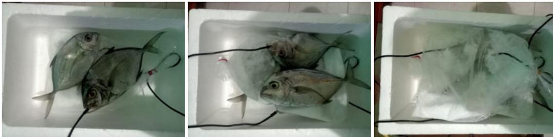
**Gambar 1** Susunan ikan dan PCM KCl/H<sub>2</sub>O dalam kotak styrofoam
