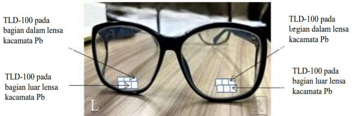
**Gambar 1** Posisi TLD-100 Pada Lensa Kacamata Pb
