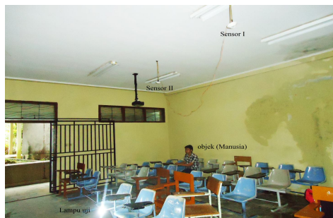
Gambar 5 Lampu menyala ketika ada orang dalam ruangan
