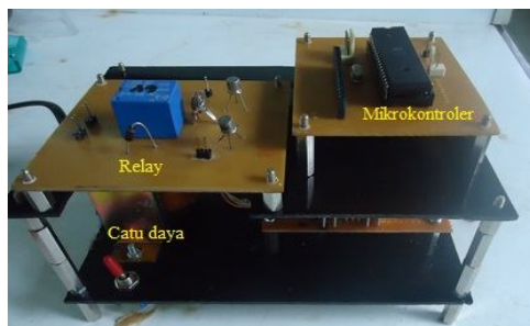
Gambar 4 Perangkat keras sistem otomasi penyalan lampu ruang kuliah berbasis mikrokontroler ATmega8535 dengan PIR Paradox-465 .
