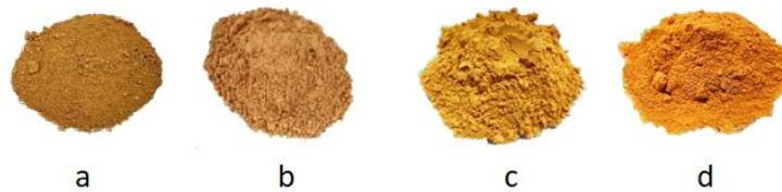
**Gambar 1.** Perubahan warna lempung setelah dimodifikasi secara termal
