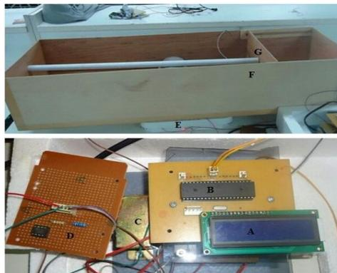
Gambar 6 Rangkaian dan mekanik alat ukur tinggi dan berat badan bayi, (A) LCD, (B) Mikrokontroler ATmega8535, (C) Catu daya, (D) Penguat Non-Inverting, (E)LED, (F) Papan triplek untuk meletakkan bayi dan (G) Plat geser
