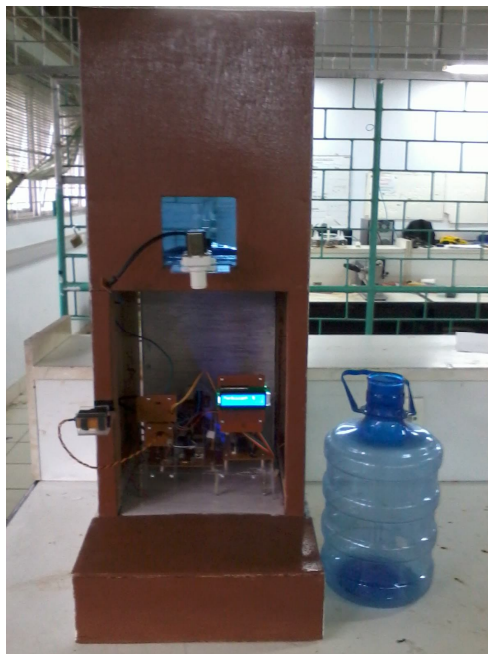
Gambar 7 Sistem otomasi depot air isi ulang yang dihasilkan dari penelitian.
