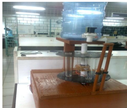
Gambar 8 Rotary sample collector yang dihasilkan dari penelitian.
